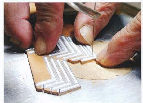
Découpe d'une charpente suivant gabarits.
