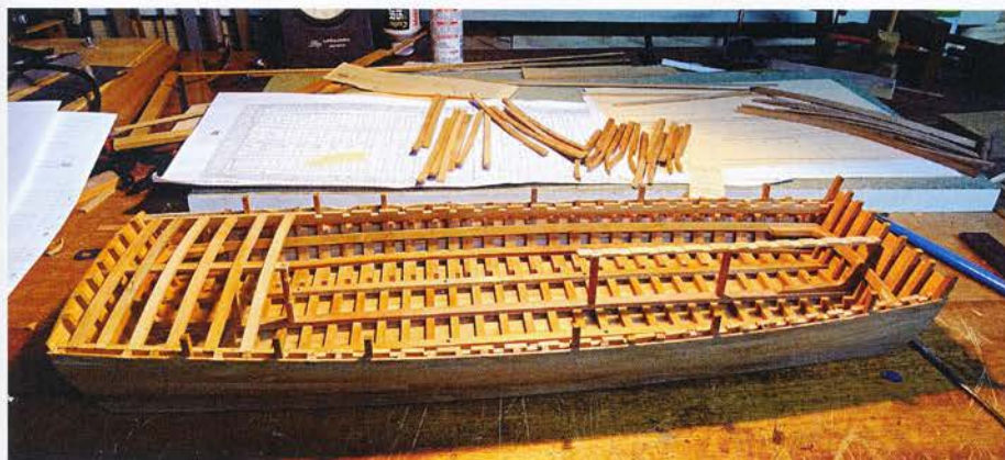
Charpente de la barge.
